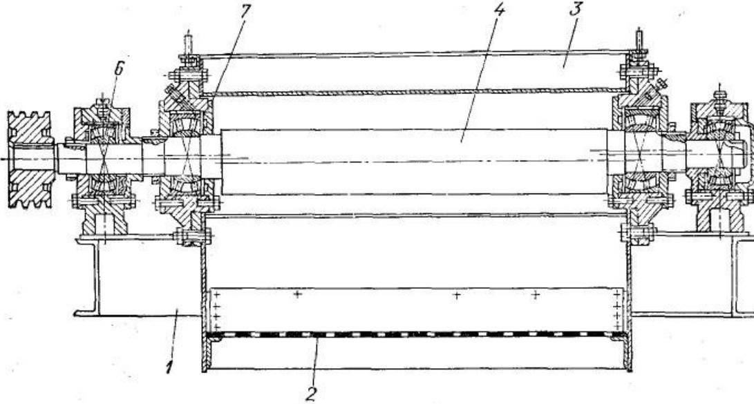
*Механическое сито (разрез)*
