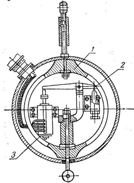
Весовой дозатор непрерывного действия:
