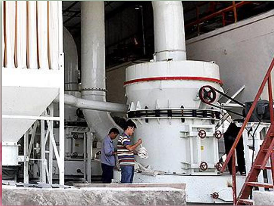
**Сухие фракции измельчаются в мельницах до состояния порошка и отправляются в печь для обжига. Порошок обжигается на протяжении 1-2 часов при температуре 150-160 градусов.**
