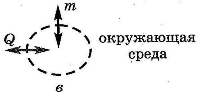
**1.1. Термодинамические системы: изолированная (а), закрытая (б) открыта (в)**
