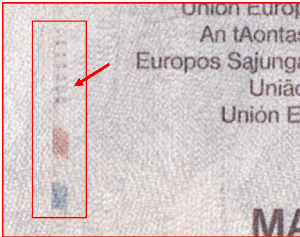
Имитация защитной нити с помощью знакосинтезирующих печатающих устройств струйной печати
