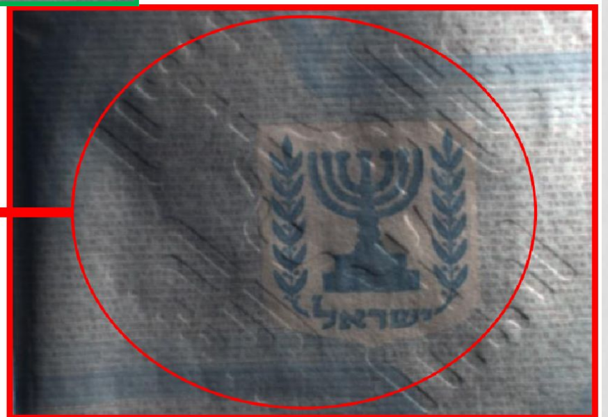
Имитация водяного знака в поддельном документе, выполненном путем тиснения
