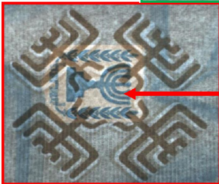
Имитация водяного знака в поддельном документе, выполненном путем тиснения
