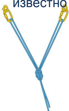
Y-образная навеска с использованием узла заячьи уши
