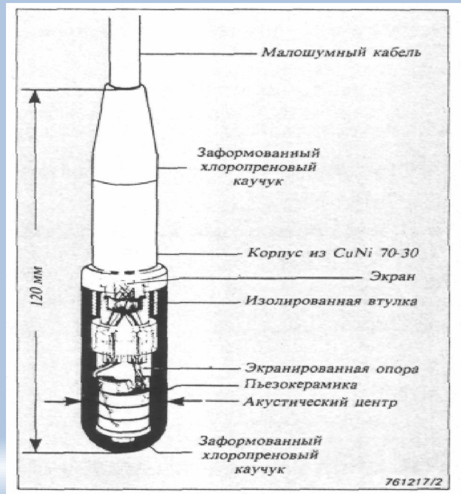
Схема конструкции гидрофона
