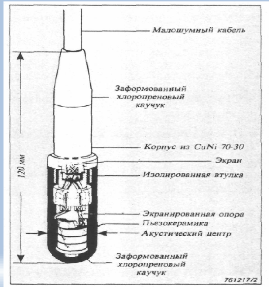
Схема конструкции гидрофона
