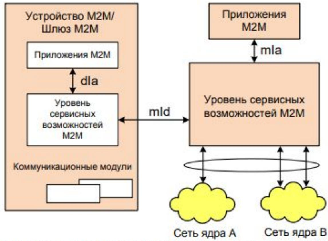
Рис. 4.3 – Интерфейсные точки функциональной архитектуры M2M (источник: ETSI)
