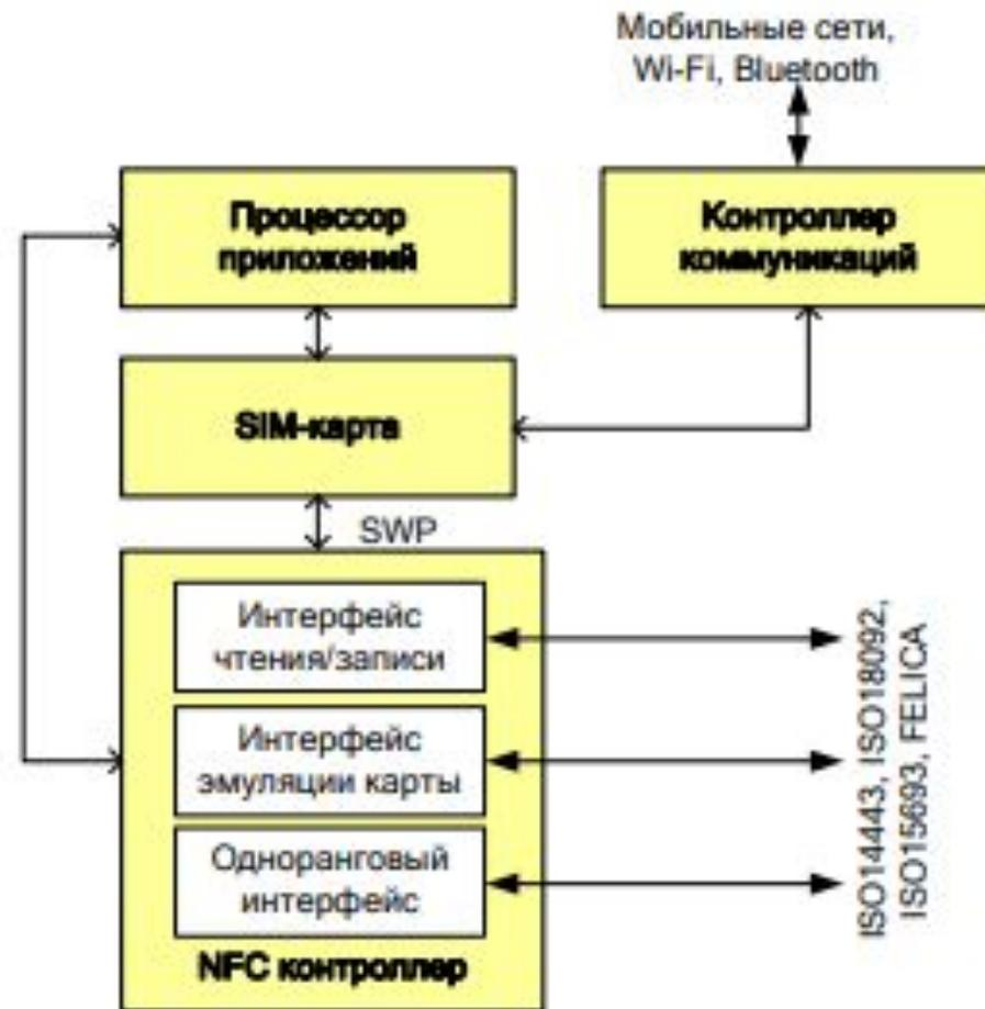
Рис. 4.6 – Структурная схема мобильного телефона с модулем NFC
