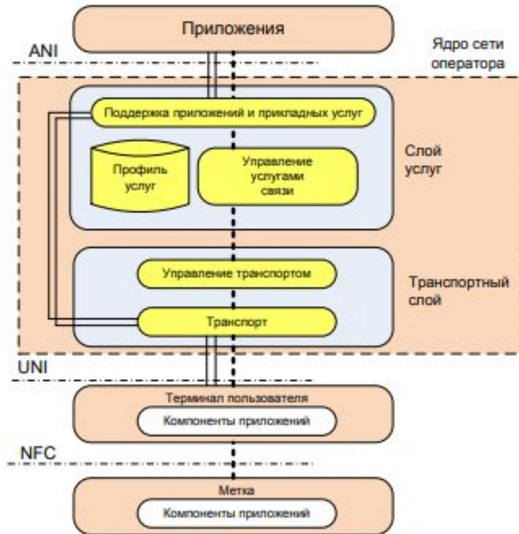
Рис. 4.4 - Место технологии NFC в архитектуре сети NGN
