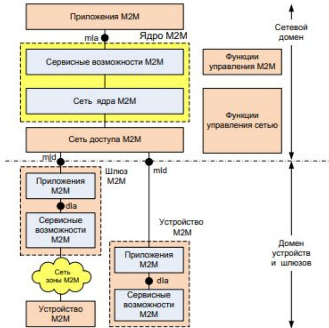
Рис. 4.2 - Высокоуровневая архитектура ETSI M2M (источник: ETSI)
