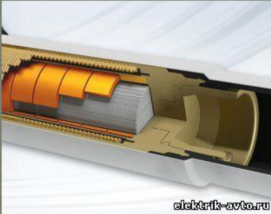
Принцип работы катушки зажигания основан на создании во вторичной обмотке высокого напряжения в момент, когда по первичной обмотке пропускается низковольтный импульс. Иными словами, при прохождении через первичную обмотку электрического тока в сердечнике создается мощное магнитное поле, которое и обеспечивает наведение повышенного напряжения во вторичной обмотке.
