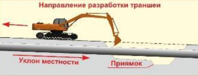
**ПЕРЕД НАЧАЛОМ КАЖДОЙ СМЕНЫ ОТКОСЫ ОСМАТРИВАЮТСЯ ПРОИЗВОДИТЕЛЕМ РАБОТ И ПРИ НЕОБХОДИМОСТИ ВОССТАНАВЛИВАЮТСЯ. ЕСЛИ У БРОВКИ ТРАНШЕИ ОБРАЗОВАЛИСЬ ТРЕЩИНЫ И ВОЗНИКЛА ОПАСНОСТЬ ОБВАЛА, РАБОТЫ В ТРАНШЕЕ ДО УСТРАНЕНИЯ ОПАСНОСТИ ПРЕКРАЩАЮТСЯ**
