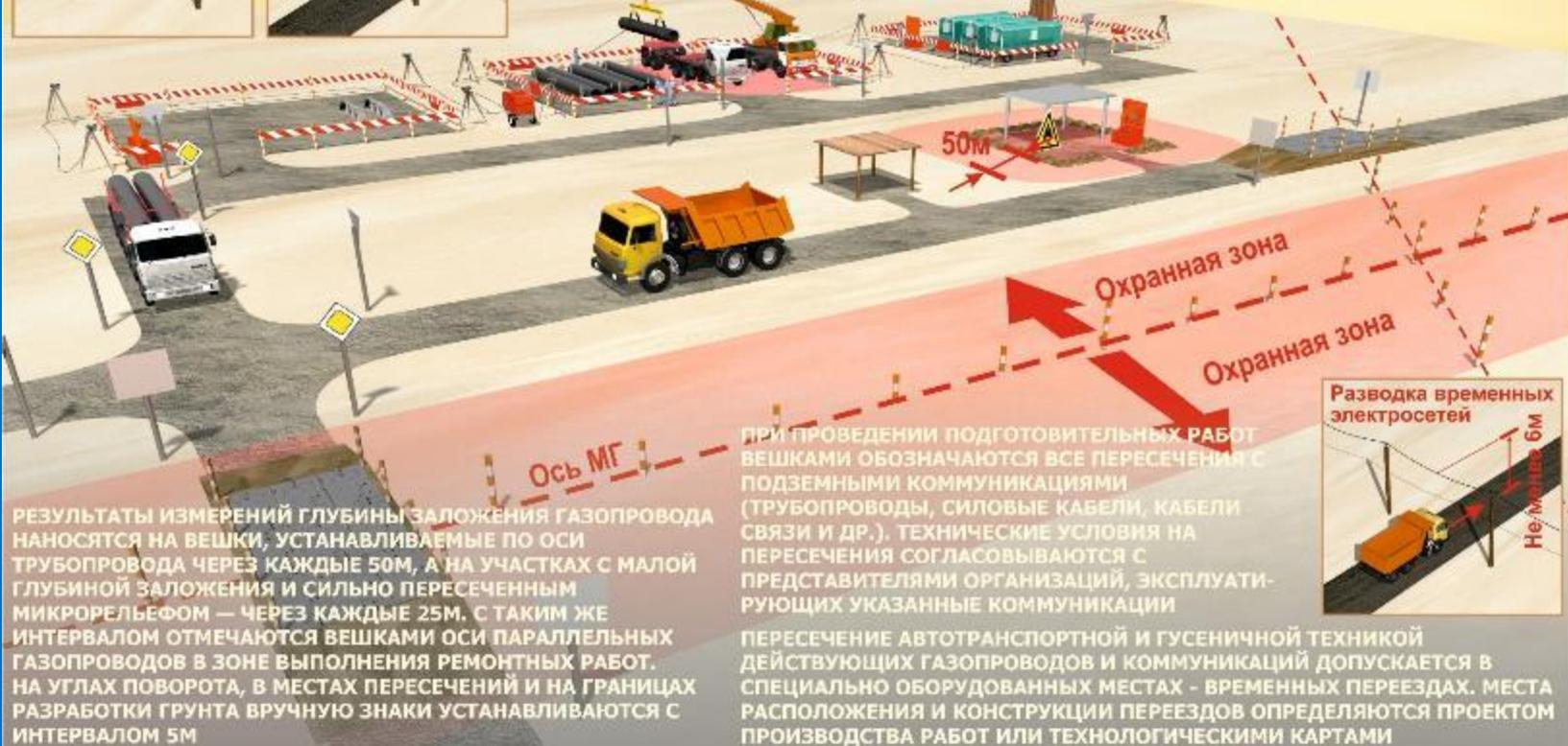
РЕЗУЛЬТАТЫ ИЗМЕРЕНИЙ ГЛУБИНЫ ЗАЛОЖЕНИЯ ГАЗОПРОВОДА НАНОСЯТСЯ НА ВЕШКИ, УСТАНОВЛИВАЕМЫЕ ПО ОСИ ТРУБОПРОВОДА ЧЕРЕЗ КАЖДЫЕ 50М, А НА УЧАСТКАХ С МАЛОЙ ГЛУБИНОЙ ЗАЛОЖЕНИЯ И СИЛЬНО ПЕРЕСЕЧЕННЫМ МИКРОРЕЛЬЕФОМ — ЧЕРЕЗ КАЖДЫЕ 25М. С ТАКИМ ЖЕ ИНТЕРВАЛОМ ОТМЕЧАЮТСЯ ВЕШКАМИ ОСИ ПАРАЛЛЕЛЬНЫХ ГАЗОПРОВОДОВ В ЗОНЕ ВЫПОЛНЕНИЯ РЕМОНТНЫХ РАБОТ. НА УГЛАХ ПОВОРОТА, В МЕСТАХ ПЕРЕСЕЧЕНИЙ И НА ГРАНИЦАХ РАЗРАБОТКИ ГРУНТА ВРУЧНУЮ ЗНАКИ УСТАНОВЛИВАЮТСЯ С ИНТЕРВАЛОМ 5М
