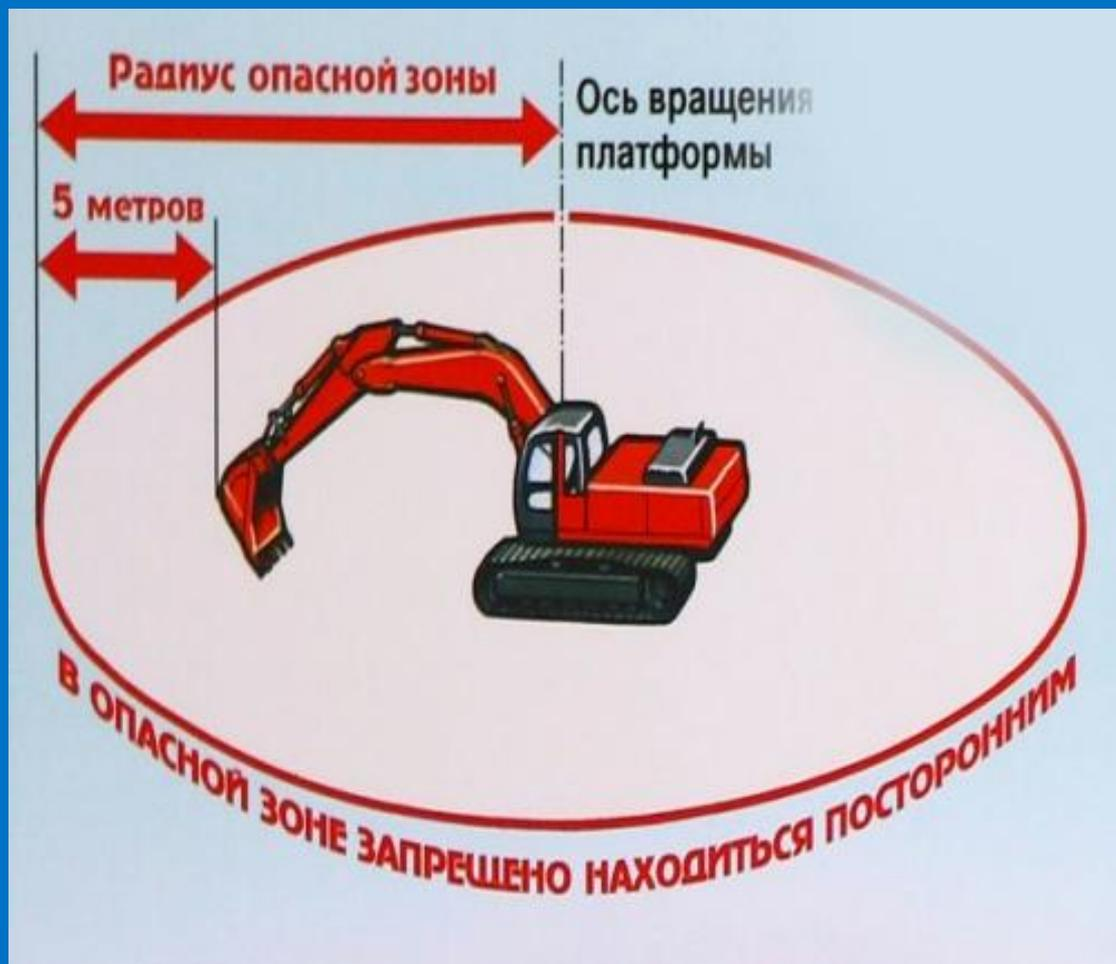
В целях предотвращения потери устойчивости и последующего падения в траншею с неукрепленными откосами, экскаватор в процессе перемещения все время должен располагаться за призмой обрушения грунта на безопасном расстоянии, установленном Проектом производства работ
