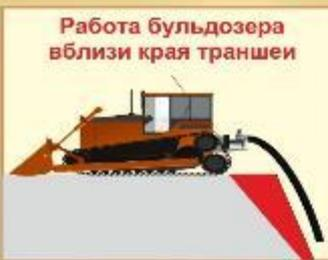
**В ВОДОНАСЫЩЕННЫХ ГРУНТАХ ВСКРЫТИЕ ГАЗОПРОВОДА НАЧИНАЕТСЯ С ПОНИЖЕНИЯ МЕСТ ДЛЯ СПУСКА И ОТКАЧКИ ВОДЫ. ПРИ ЗНАЧИТЕЛЬНОМ ПРИТОКЕ ВОДЫ ПОНИЖЕННОЕ МЕСТО ВЫНОСИТСЯ В СДЕЛАННОЕ ДЛЯ ЭТОГО МЕСТО РАСШИРЕНИЕ ТРАНШЕИ**
