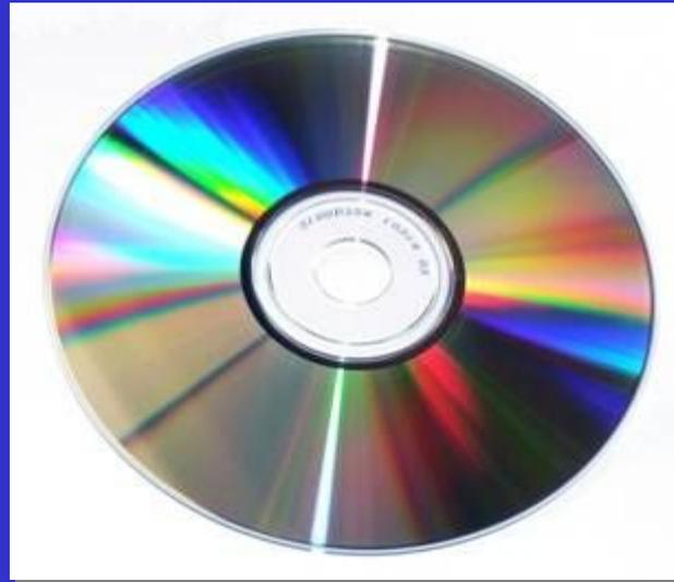
*Оптический диск* это носитель информации, запись и считывание с которого осуществляется оптическим путем (лучом лазера). Оптические носители бывают однократной и многократной записи. Имеется много форматов оптических дисков, наиболее распространенными являются CD, емкостью 700 Мбайт, и DVD, емкостью 4.7 Гбайт.
