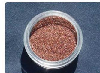
Наиболее распространенная фракция для очистки поверхности – Mesh 30/60(0.25-0.6 мм), также используется Mesh 80(0,15-0,4 мм)
