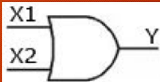
Рис. 3 Или в зарубежных схемах
