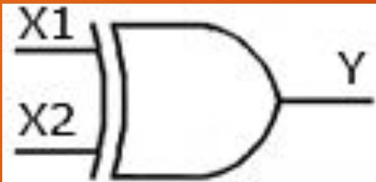
*Рис. 6 Искл. или в зарубежных схемах*
