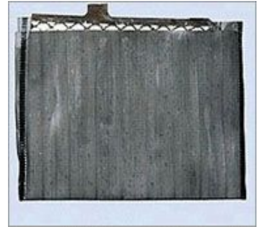
Низкие сепараторы-конверты, приводящие к короткому замыканию.
