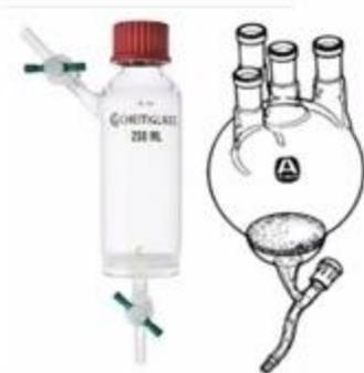
Проточные реакторы для SPS
