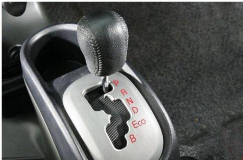
**P (парковка)** — положение, которое позволяет осуществить запуск двигателя. Рычаг переводится в позицию P лишь после того, как автомобиль полностью остановлен и поставлен на ручной тормоз.
