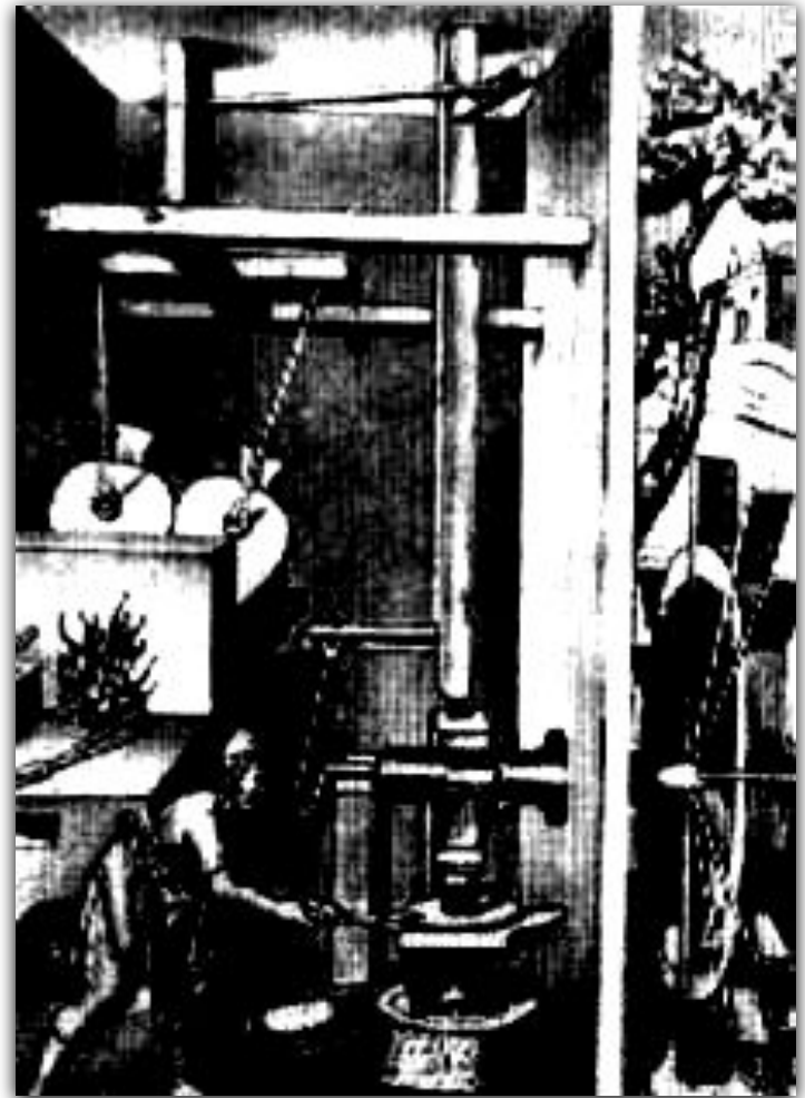
Кузница с водяным двигателем. Гравюра 16 в.
