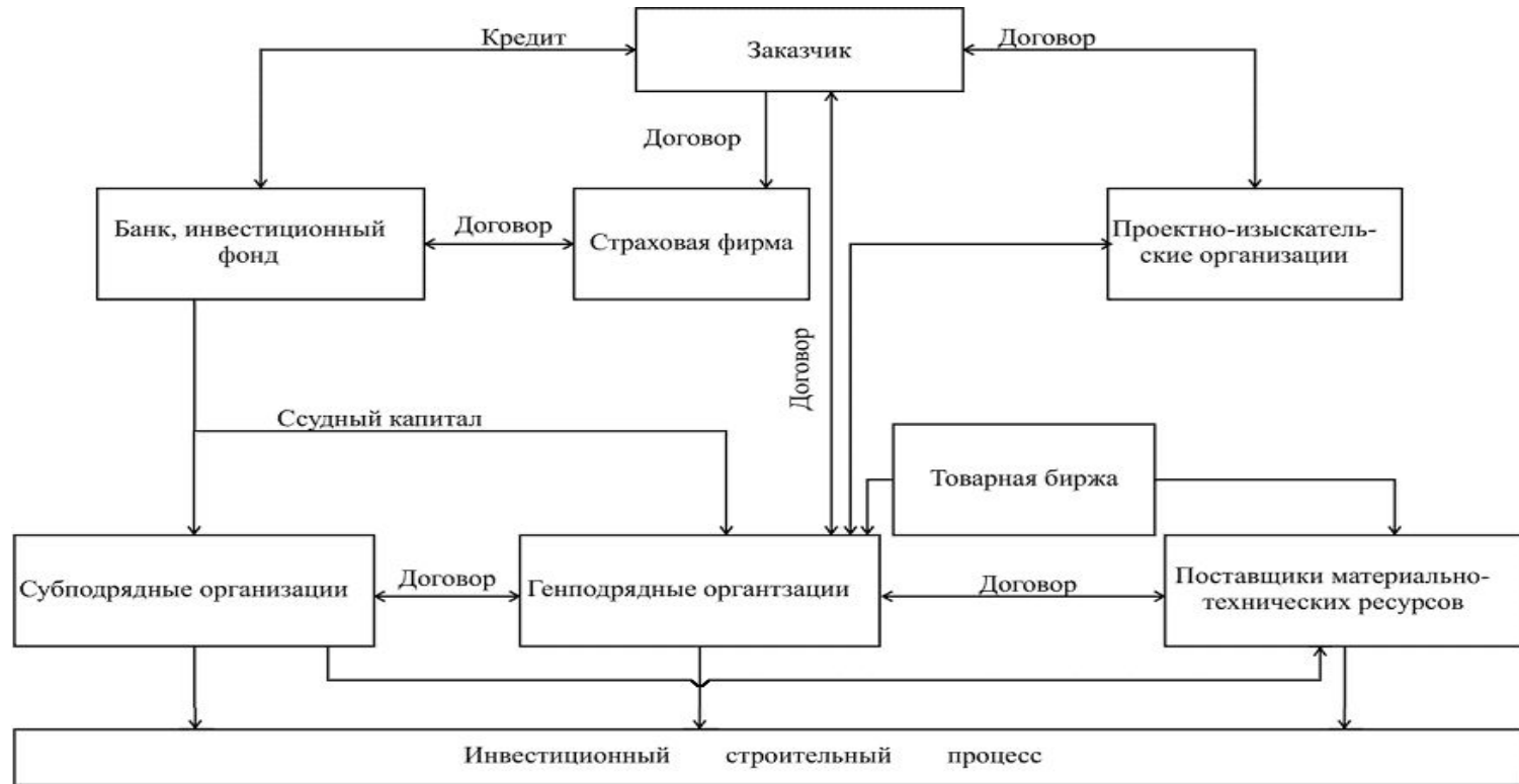
Рис. 1.1. Общая схема взаимодействия основных участников строительства
