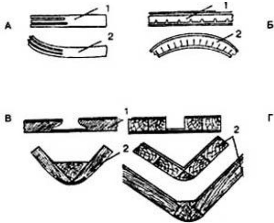
Сур. 2. Июпропил дайындамалары: а — бөлшектердің ұштарындағы бойлық кесінділері бар; Б — плиталардағы кесінділері бар; В, Г — плиталардағы ойықтары бар; 1-Дайындамалар; 2-Дайын торантар
