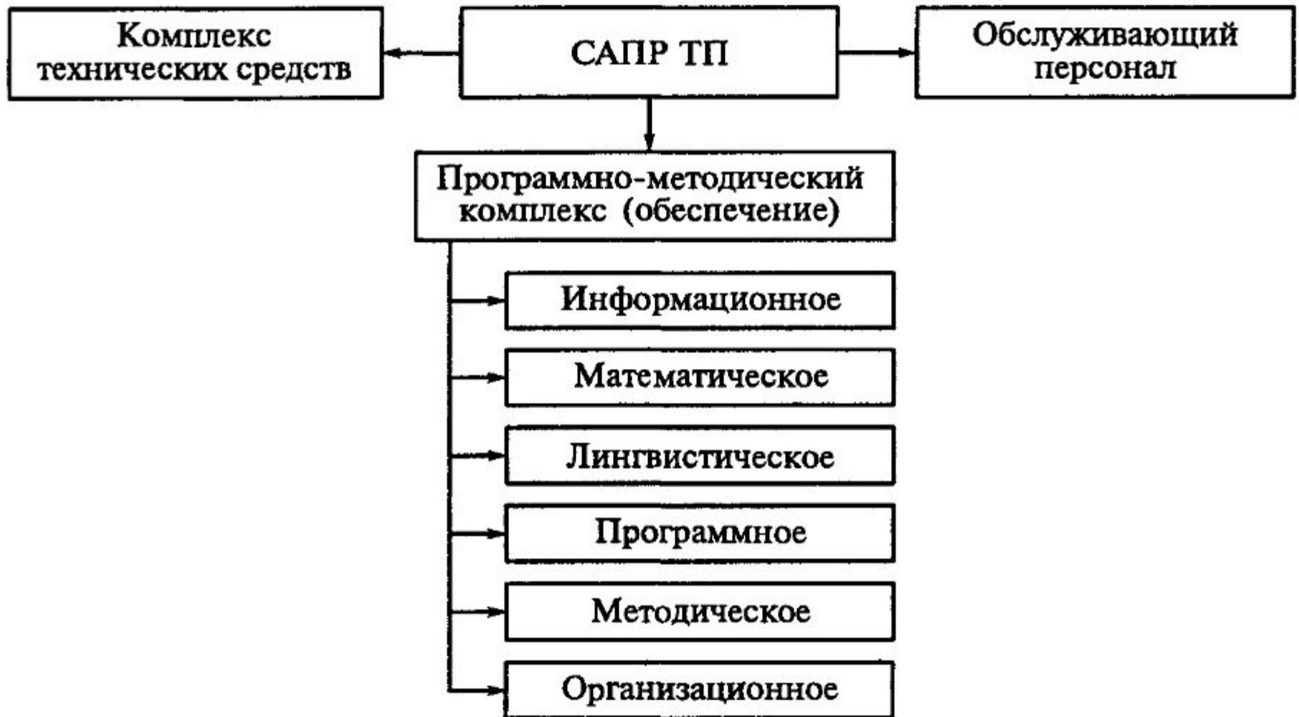
Программно-методический комплекс САПР ТП включает в себя (ГОСТ 34.033-90 «Автоматизированные системы. Термины и определения») обеспечение:
