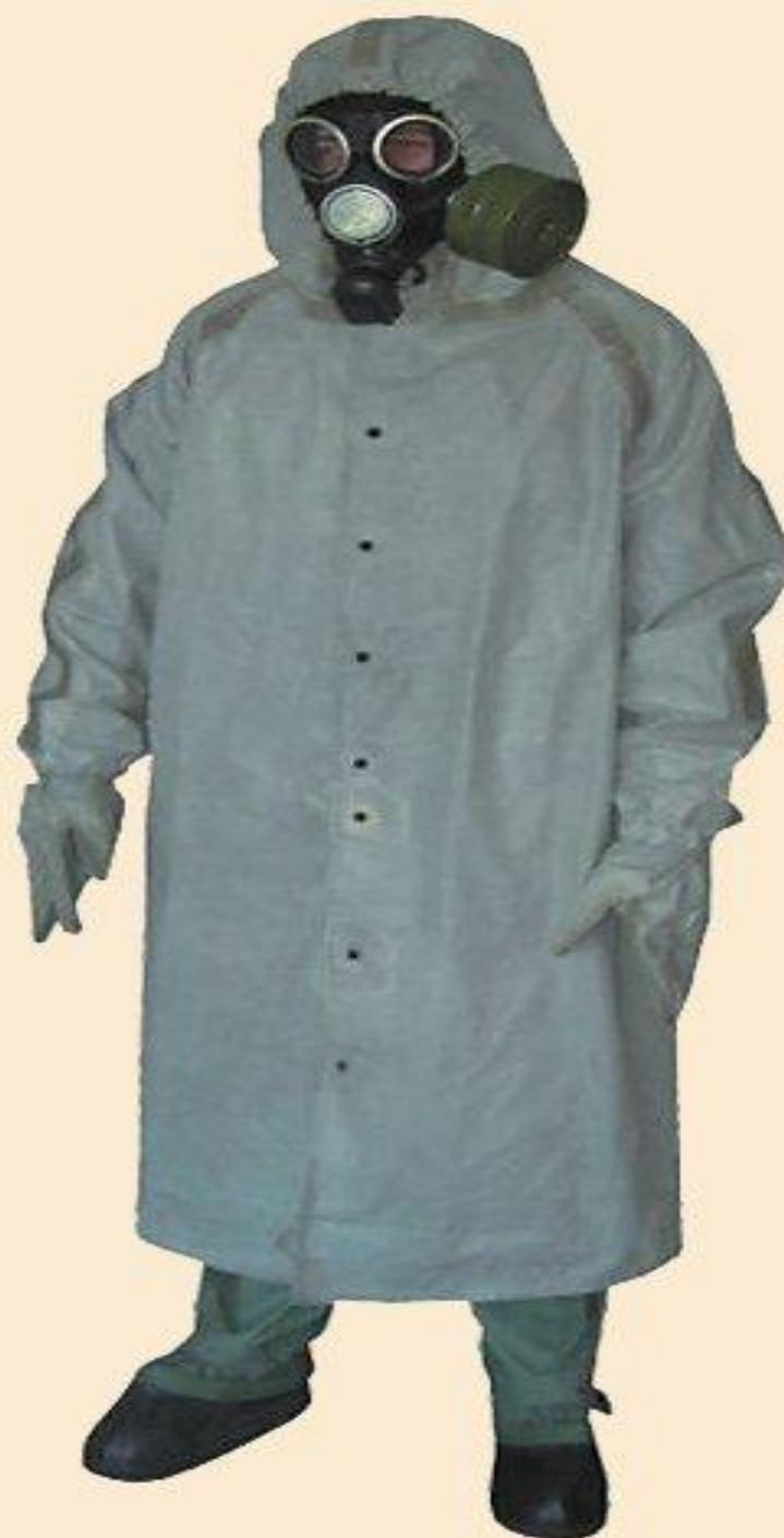
Фильтрующие средства защиты кожи изготавливают в виде хлопчатобумажного обмундирования и белья, пропитанных специальными химическими веществами. Пропитка тонким слоем обволакивает нити ткани, а промежутки между нитями остаются свободными; вследствие этого воздухопроницаемость материала в основном сохраняется, а пары ОВ при прохождении зараженного воздуха через ткань поглощаются.
