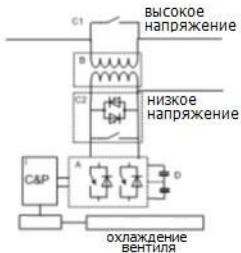
Рис. 16. Одиночный преобразователь напряжения в последовательном включении в линию
