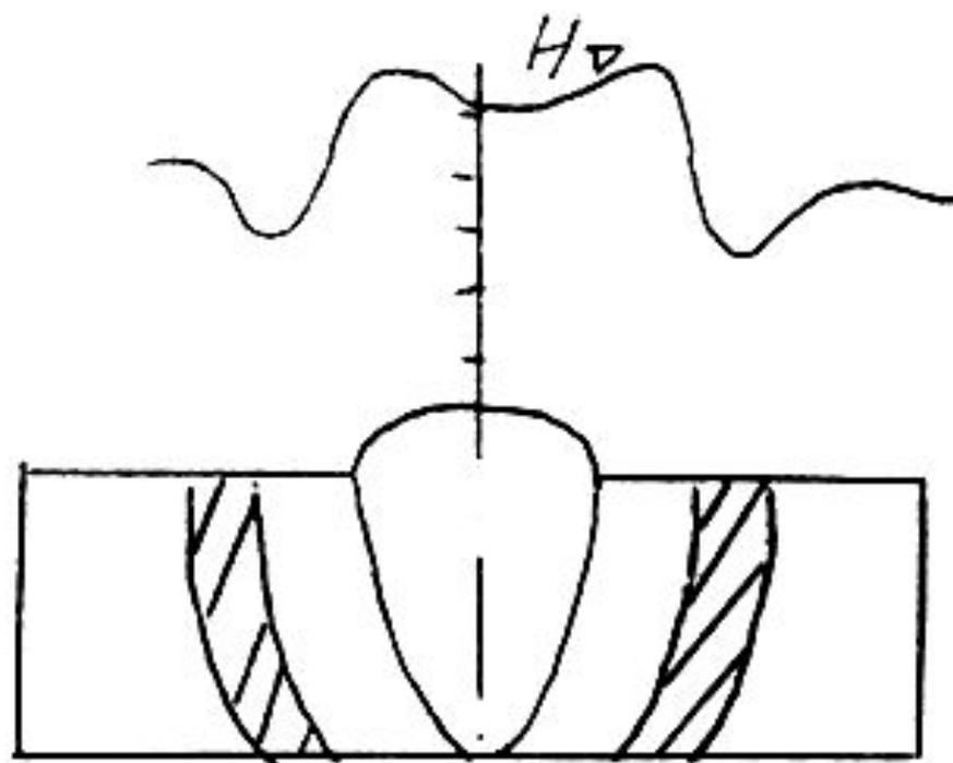
Рис.1.График изменения твердости в сварном соединении.
