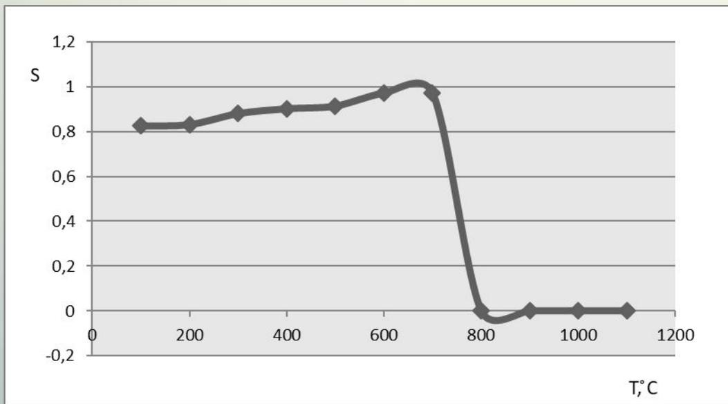
рис. 11 Зависимость спектрального критерия (S) от температуры (T) ( $S=D_{875}/D_{1080}$ )
