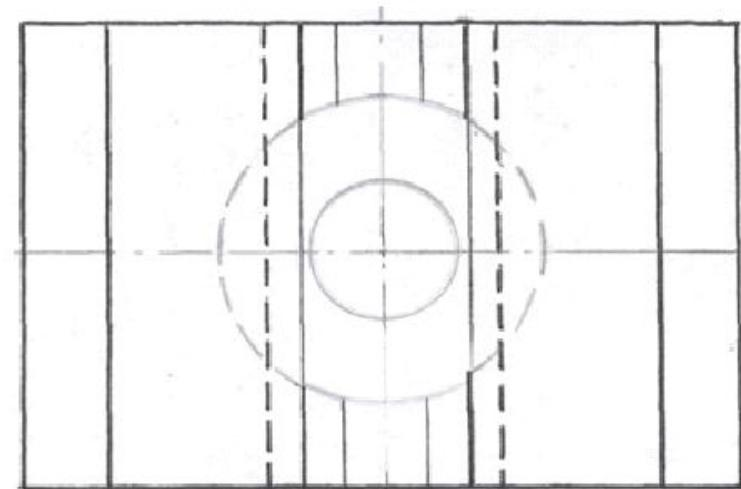
Чтобы яснее показать внутреннее устройство детали, применяют изображения, называемые **разрезом**.
