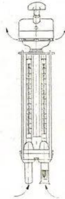
Рис.3.3. Аспирационный психрометр Ассман
