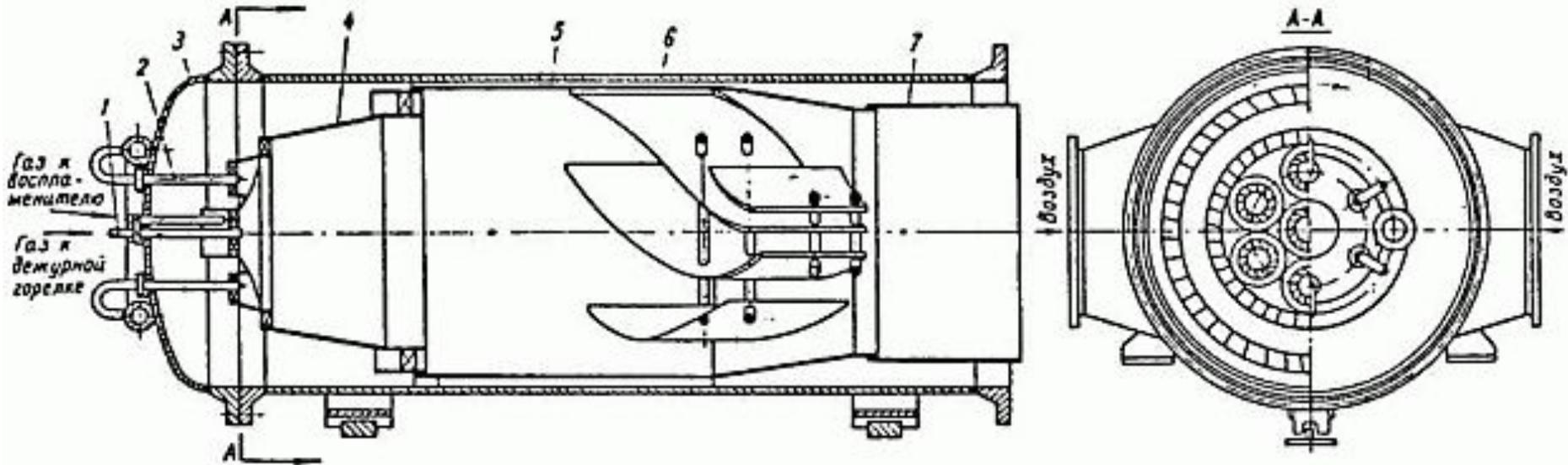
1 – дежурная горелка с воспламенителем, 2 – основные горелки (6 шт.), 3 – крышка, 4 – фронтное устройство, 5 – огневая часть, 6 – корпус камеры, 7 - секция
