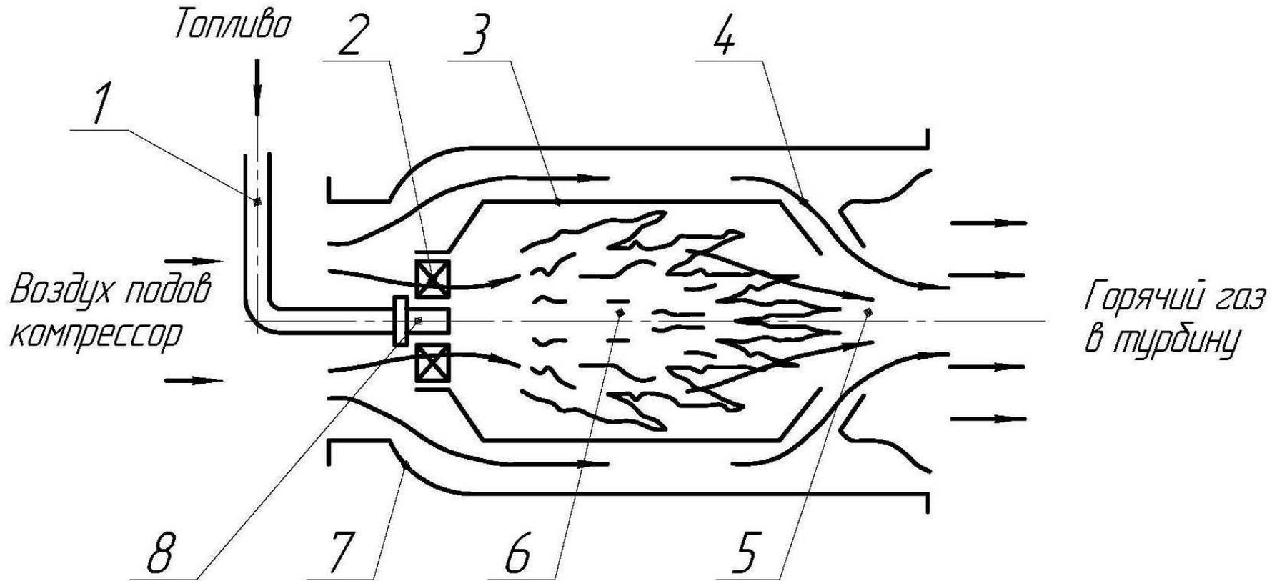
1 – подвод топлива, 2 – регистр подачи первичного воздуха, 3 – пламенная (жаровая) труба, 4 – смеситель, 5 – зона смешения, 6 – зона горения, 7 – корпус, 8 – топливораздающее устройство (горелка или форсунка)
