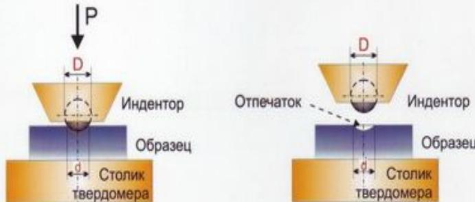
Схема определения твердости по Бринеллю
