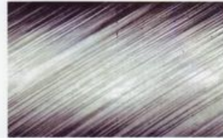
Полосы скольжения в деформированном алюминии
