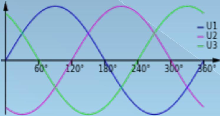
**Трёхфазной системой** называется совокупность трёх однофазных электрических цепей, в которых действуют три электродвижущие силы одинаковой частоты, сдвинутые по фазе относительно друг друга на угол
