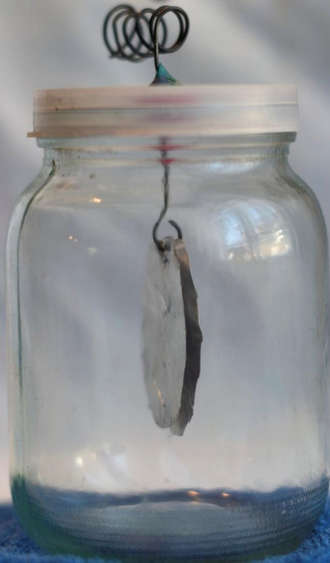
*Прибор для измерения электрического заряда*
