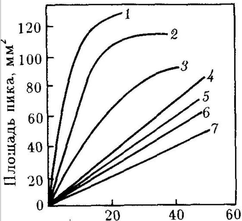
**Рис. VII.21.** Градуировочный график для определения галоидуглеводородов с ЭЗД, полученный с помощью проницаемых трубок [111]. 1 —  $\text{CCl}_4$ ; 2 —  $\text{CCl}_3\text{F}$  (фреон 11); 3 —  $\text{C}_2\text{Cl}_4$ ; 4 —  $\text{CCl}_2\text{F}_2$  (фреон 12); 5 —  $\text{CH}_3\text{CCl}_3$ ; 6 —  $\text{C}_2\text{F}_3\text{Cl}_3$  (фреон 113);
