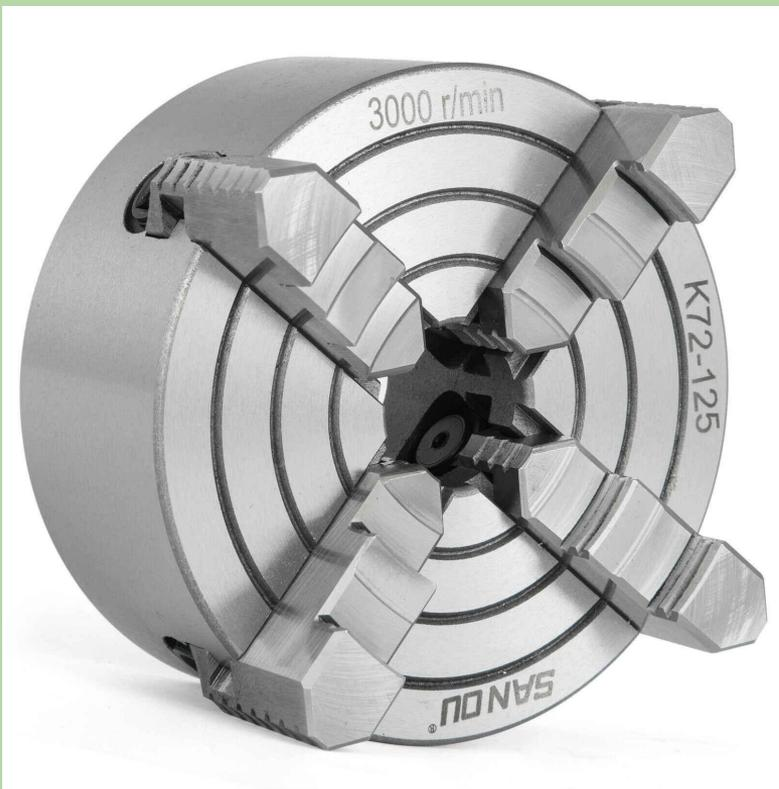
**Четырехкулачковый патрон** применяется при обработке несимметричных заготовок. Позволяет проточить деталь вне центра или при расточке отверстий по разным осям. Изделие крепится двумя парами независимых держателей во взаимоперпендикулярных плоскостях и обеспечивает полное совпадение оси шпинделя с обрабатываемой поверхностью. Кулачок может быть цельным или сборным.
