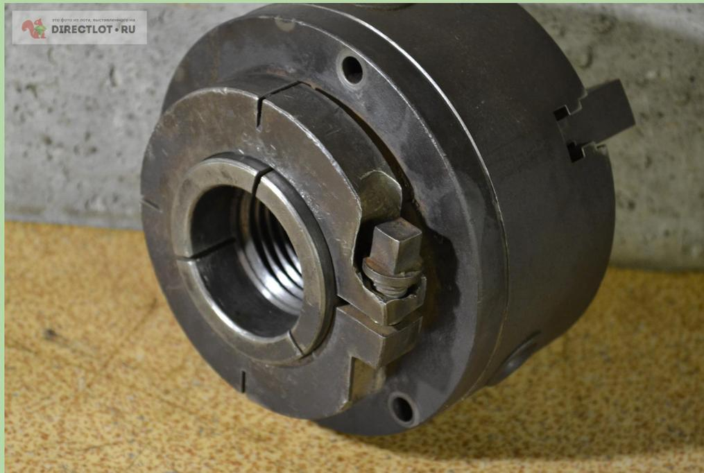
Токарный патрон, предназначенный для установки на резьбовой конец шпинделя
