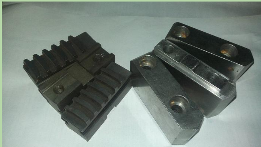
Конструкция составных кулачков: слева рейки с гребенками, справа - накладка
