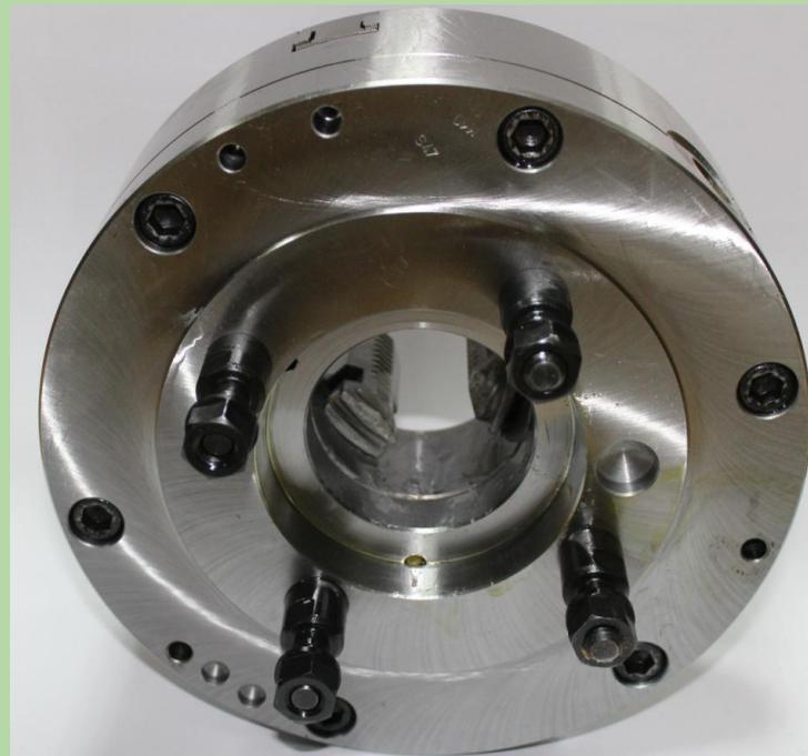
Токарный патрон, предназначенный для установки на фланцевый конец шпинделя с поворотной (байонетной) шайбой
