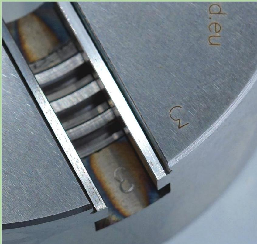
Кулачки патрона имеют порядковый номер, такой же, как и пазы в патроне, в которые они установлены. Номера кулачков выбиваются на нерабочих поверхностях их пазов, а номера гнезд патрона, соответствующие кулачкам — на внутренних торцах кулачковых пазов.
