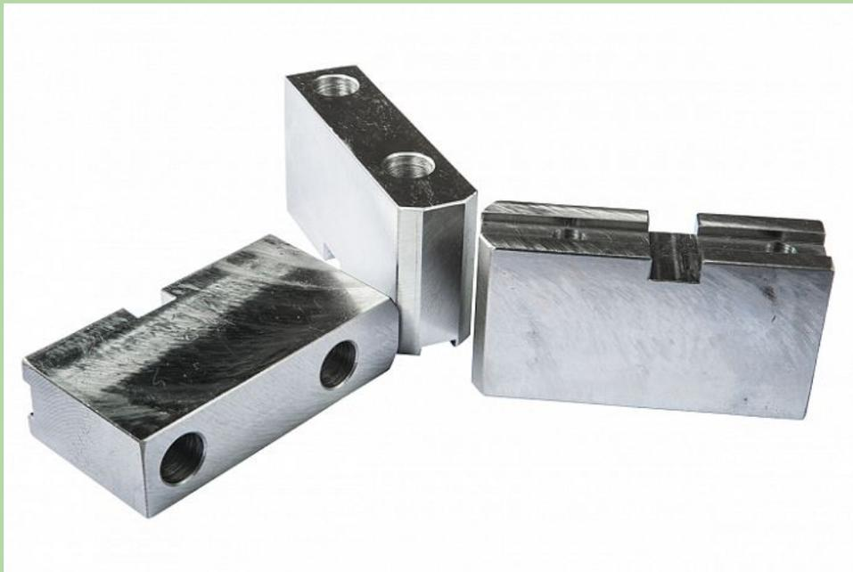
Накладные кулачки изготавливаются непосредственно токарями из сталей или цветных металлов без дополнительной термической обработки, в связи с чем, ещё именуются «сырыми» кулачками. Крепятся к рейкам (поставляются в комплекте к патрону), что устанавливаются вместо прямых или обратных кулачков.
