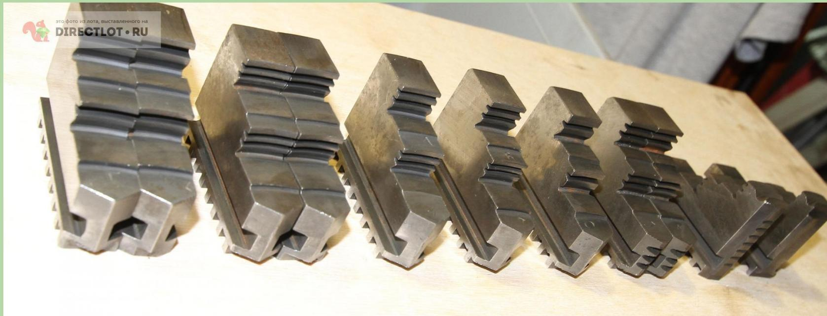
**Кулачки** токарного патрона предназначены для центрирования и фиксации заготовки в рабочей зоне и являются составной частью зажимного устройства любого станка или обрабатывающего центра.
