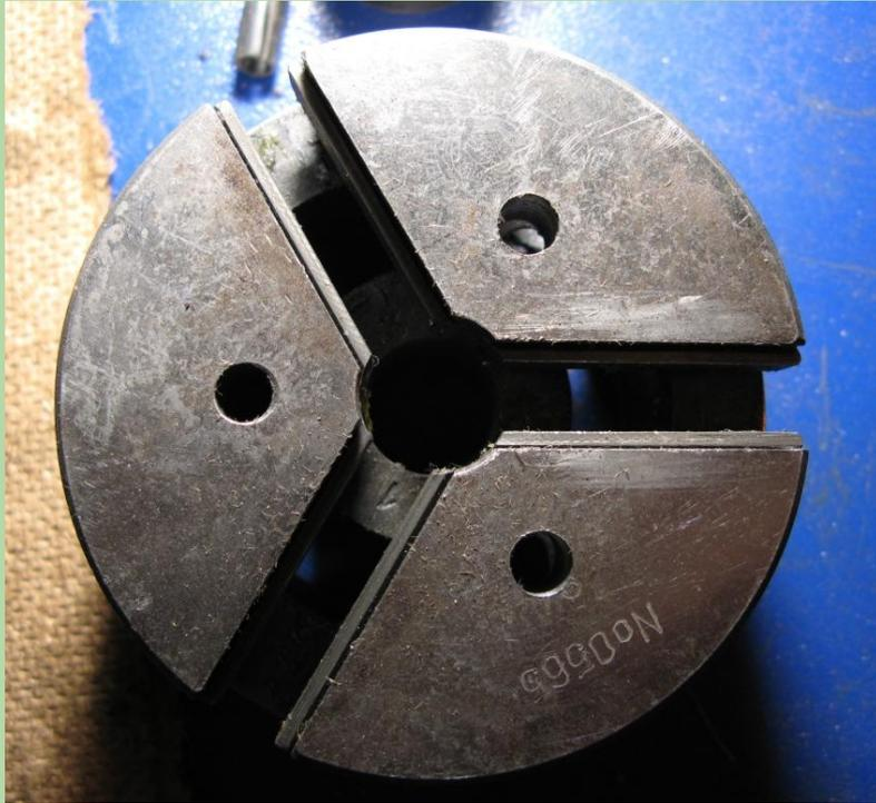
Корпус патрона бывает монолитным (корпус – одна базовая деталь) или составным (корпус разделён на две базовые детали) с тремя радиальными пазами для кулачков.
