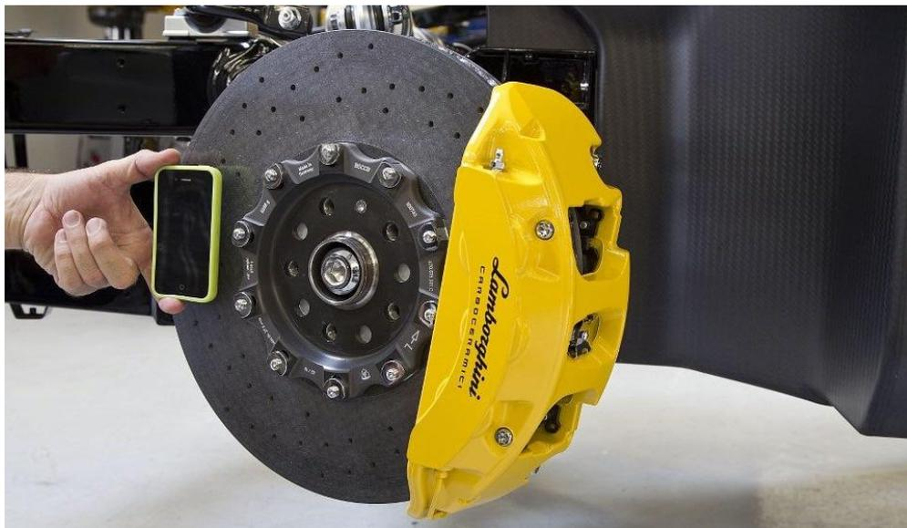
Определившись с выбором дисков, важно вместе с ними покупать и предназначенные для них суппорта. Тюнинговые суппорта изготавливаются из алюминия и имеют вместо одного несколько поршней. Многопоршневые суппорта равномерно распределяют давление по тормозному диску, что значительно уменьшает тормозной путь автомобиля и эффективность торможения. Алюминиевый сплав значительно легче чугуна, что положительно влияет на подвеску транспортного средства.
