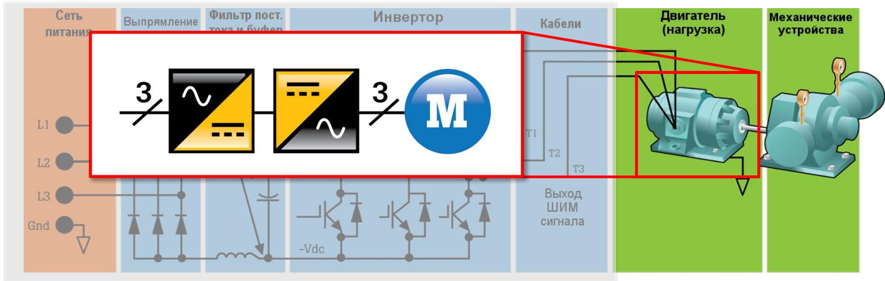
После преобразования 3-фазного напряжения переменного тока в постоянный ток, модулированное шириной импульса постоянное напряжение используется для формирования управляемого трехфазного выходного напряжения для обеспечения работы двигателя
