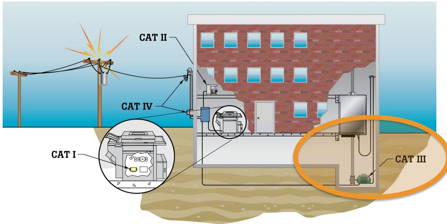
Устройства, подключенные к трехфазной сети, такие, как распределительные устройства и многофазные двигатели, установленные стационарно.
