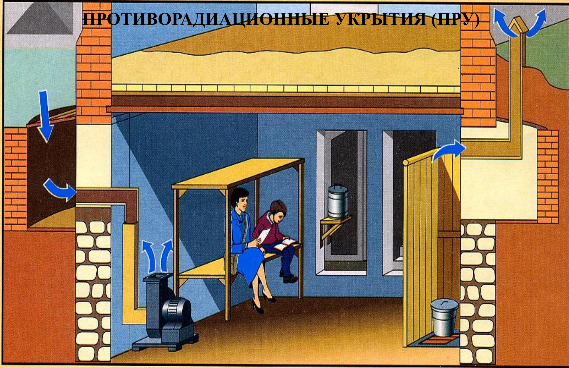
Подвал одноэтажного здания, приспособленный под противорадиационное укрытие
