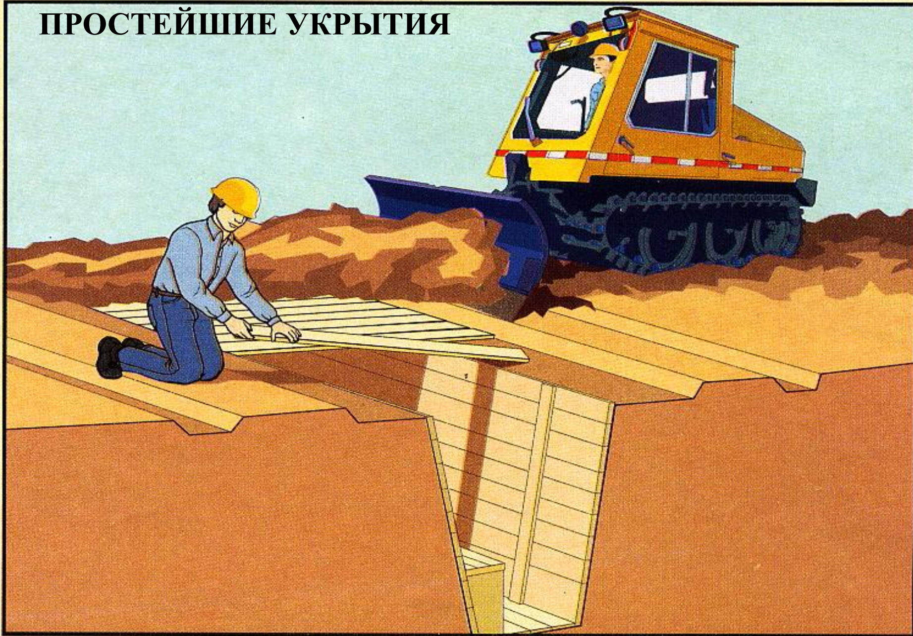
Оборудование перекрытой щели
