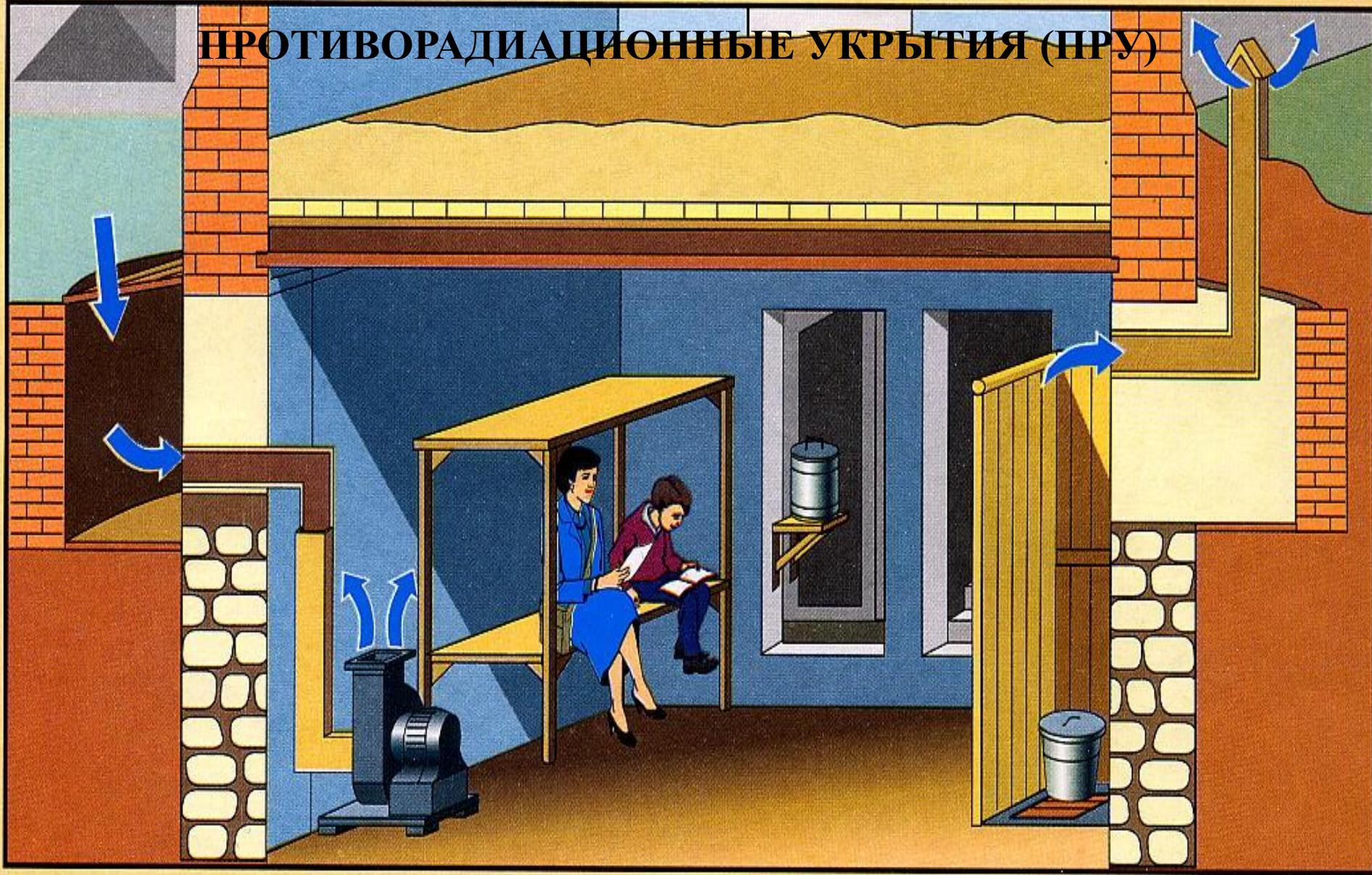
Подвал одноэтажного здания, приспособленный под противорадиационное укрытие
