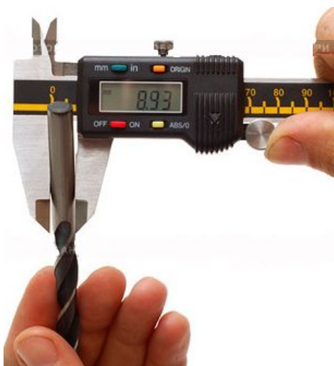
Измерение диаметра детали штангенциркулем с цифровым индикатором типа ШЦЦ-2
