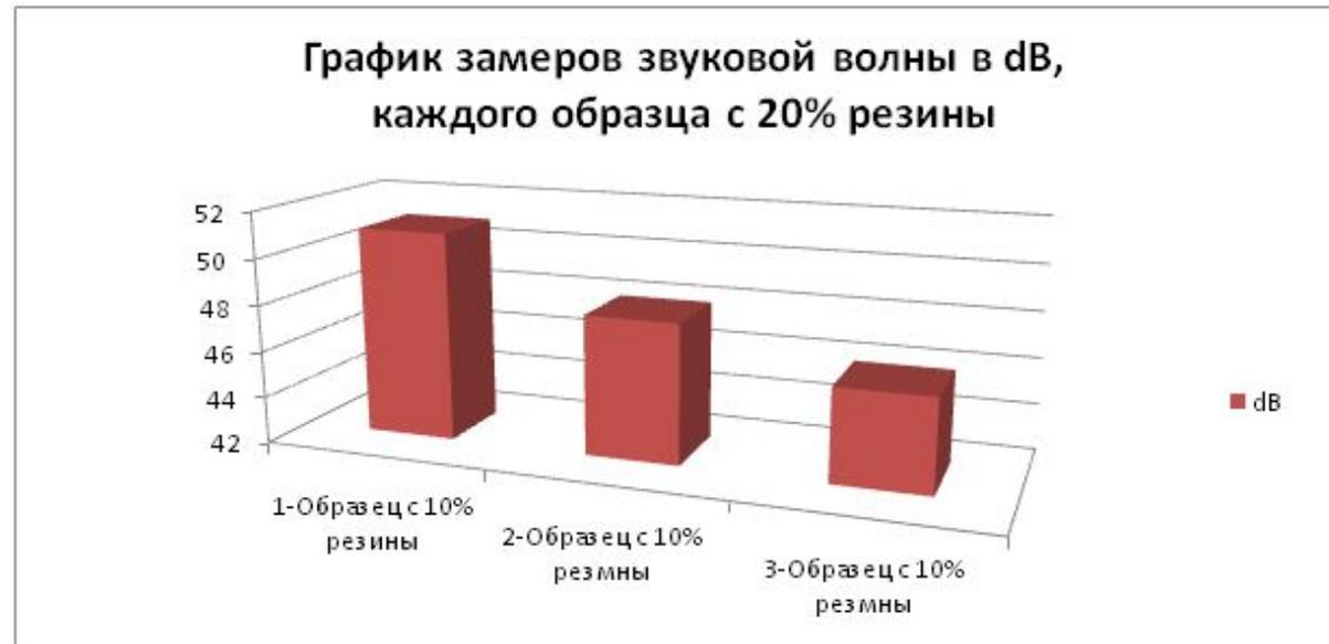
При замере бетонного образца с 20% резины, Шумомер –dB показал среднюю громкость в 48 dB. Если сравнивать с образцом без резины, который показал среднюю громкость в 58 dB. То можно сказать, что образец с 20% резины уменьшил проходимость звука на 10 dB, что уже позволяет нам сказать, что использование перемолотой автомобильной резины в бетоне может дать положительный результат. Продолжим исследование, последнего образца с 30% резины.
