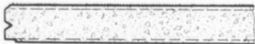
Двухслойная ячеистобетонная с внешним декоративным слоем
