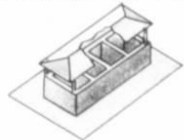
Вывод на крышу вентиляционной шахты
