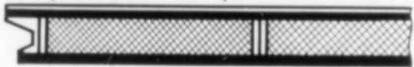
Трехслойная из двух железобетонных плит с керамзитобетонными перемычками, утепленная минеральным войлоком
