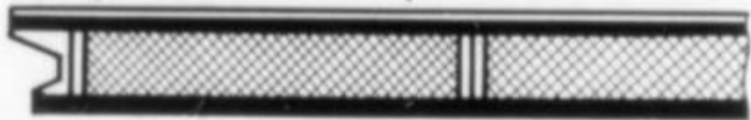
Трехслойная из двух железобетонных плит с керамзитобетонными перемычками, утепленная минеральным войлоком
