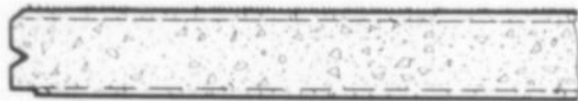
Двухслойная ячеистобетонная с внешним декоративным слоем
