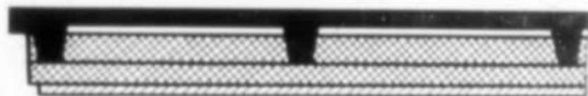
Цветное закаленное стекло, утепленное пеностеклом, внутренняя облицовка из древесностружечных плит
