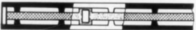
Двухскорлупная из прокатных панелей, утепленная минеральной ватой
