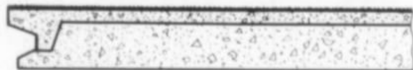
Трехслойная из двух железобетонных плит с керамзитобетонными перемычками, утепленная минеральным войлоком
