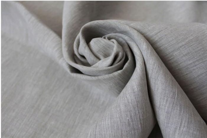
Лавсан: высокая износостойкость и светостойкость, не мнётся, отличный перенос влажно-тепловой обработки, главный недостаток – сильно электризуется.
