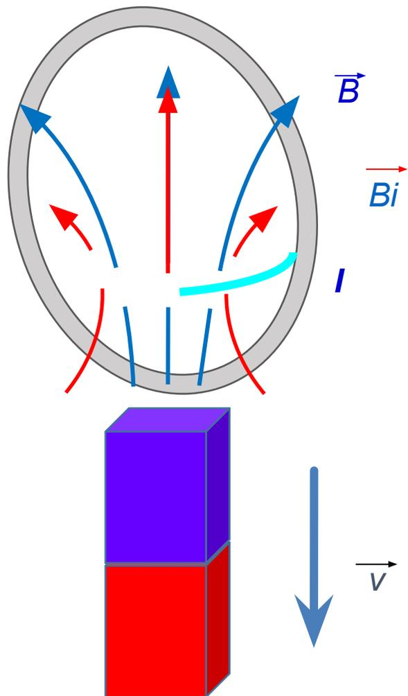
При **удалении** магнита от замкнутого контура уменьшается магнитный поток через поверхность, ограниченную контуром
