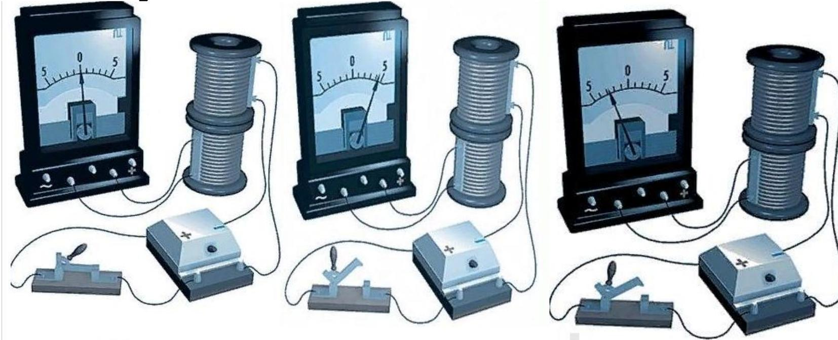
**Объяснение опыта:** электрический ток в катушке 2 возникает в моменты замыкания и размыкания ключа в цепи катушки 1. Видно, что направление тока зависит от того, замыкают или размыкают цепь катушки 1, т.е. от того, увеличивается (при замыкании цепи) или уменьшается (при размыкании цепи) магнитный поток, пронизывающий 1-ю катушку.
