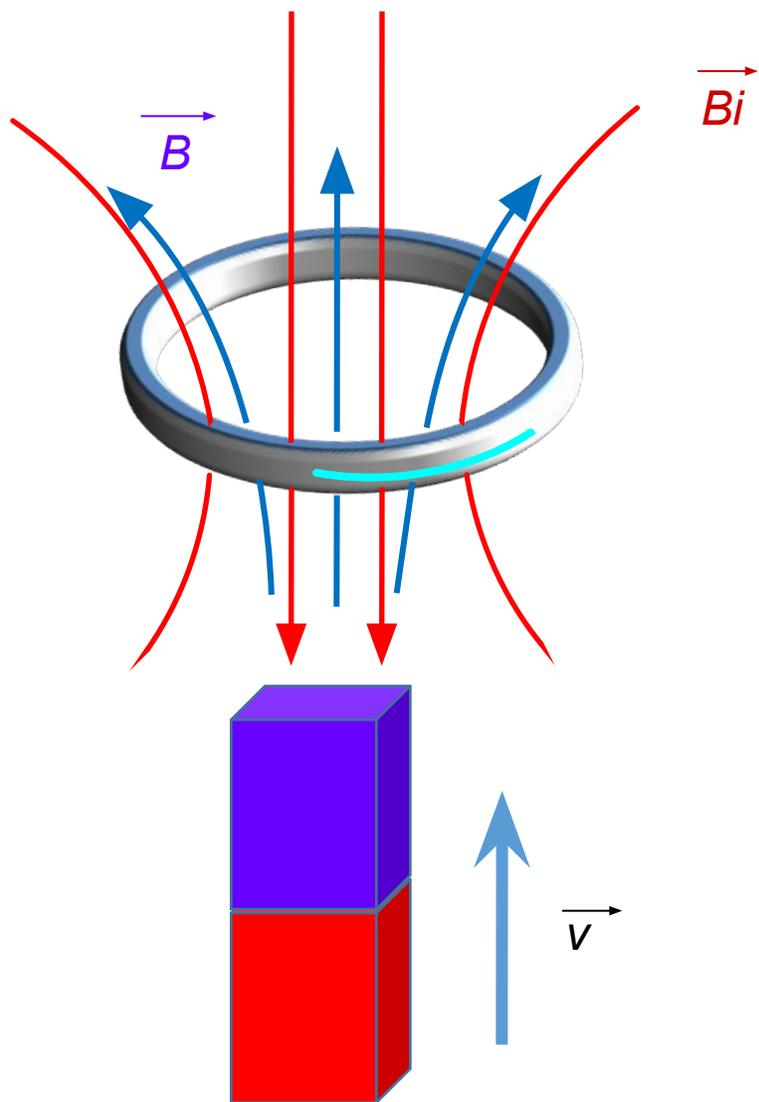
При **приближении** магнита к замкнутому контуру увеличивается магнитный поток через поверхность, ограниченную контуром
