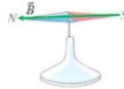
Вектор индукции магнитного поля  $\vec{B}$  направлен от южного полюса  $S$  стрелки (свободно вращающейся в магнитном поле) к северному  $N$ .
