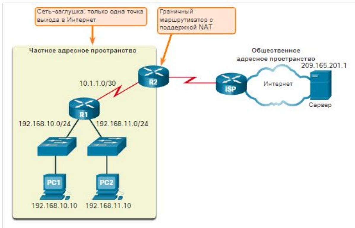
Когда устройство внутри тупиковой сети хочет связаться с устройством за пределами своей сети, пакет пересыпается на граничный маршрутизатор. Пограничный маршрутизатор выполняет процесс NAT, преобразуя внутренний частный адрес устройства в общедоступный внешний маршрутизируемый адрес.
