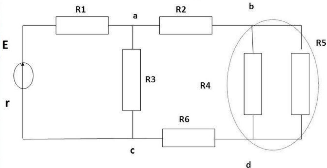
**Рис 2.** Резисторы R2 R45 R6 соединены последовательно. Найдем их эквивалентное сопротивление:
