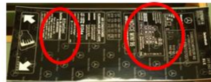
Знаки и панели кузова с VIN, например
