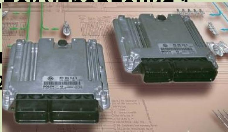
**К основным функциям относятся, например, управление клапанами насос-форсунок и клапанами перепуска отработавших газов.**
