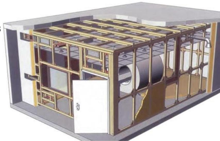
Для экранировки кабеля необходимо создать клетку Фарадея с хорошо проводящей поверхностью по всей длине экранируемых проводников. Для того чтобы клетка Фарадея эффективно работала, размер ячейки сетки должен быть значительно меньше длины волны излучения, защиту от которого требуется обеспечить.
