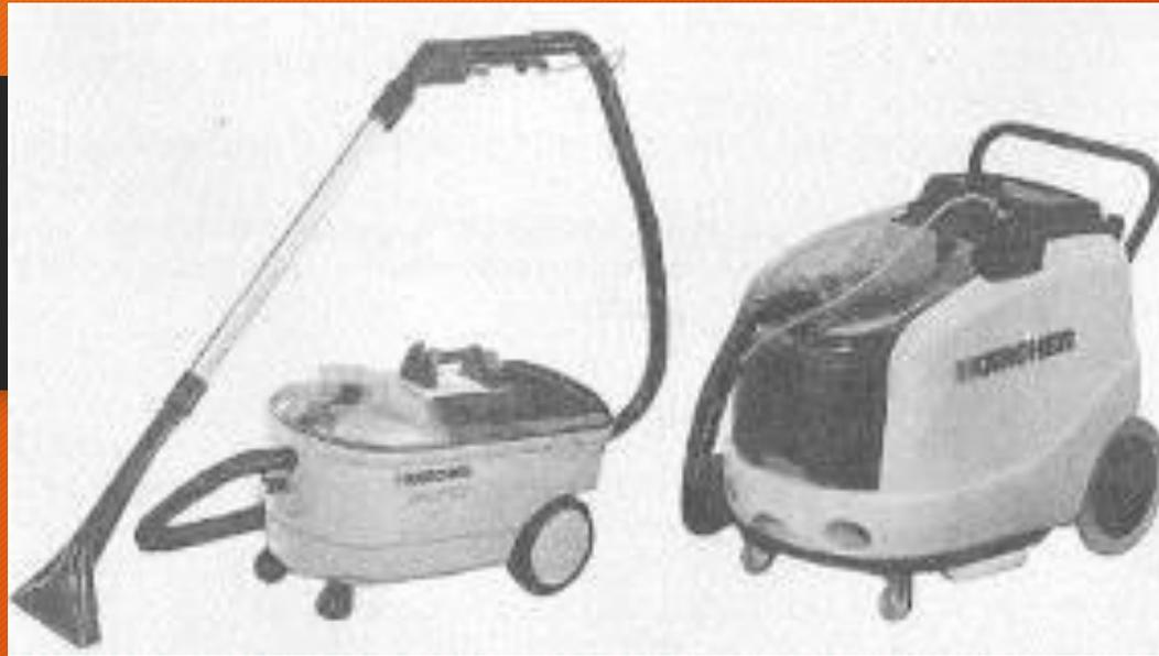
Моющие пылесосы имеют следующее устройство. В средней части пылесоса расположен турбонасос с панелью управления. По обе стороны от насоса расположены два бака: для чистой воды, в которую добавляется моющее средство, и для грязной воды. Опорожнение бака с грязной водой осуществляется путем его опрокидывания или через сливной шланг. Прозрачная крышка бака для грязной воды позволяет осуществлять визуальный контроль за заполнением бак.
