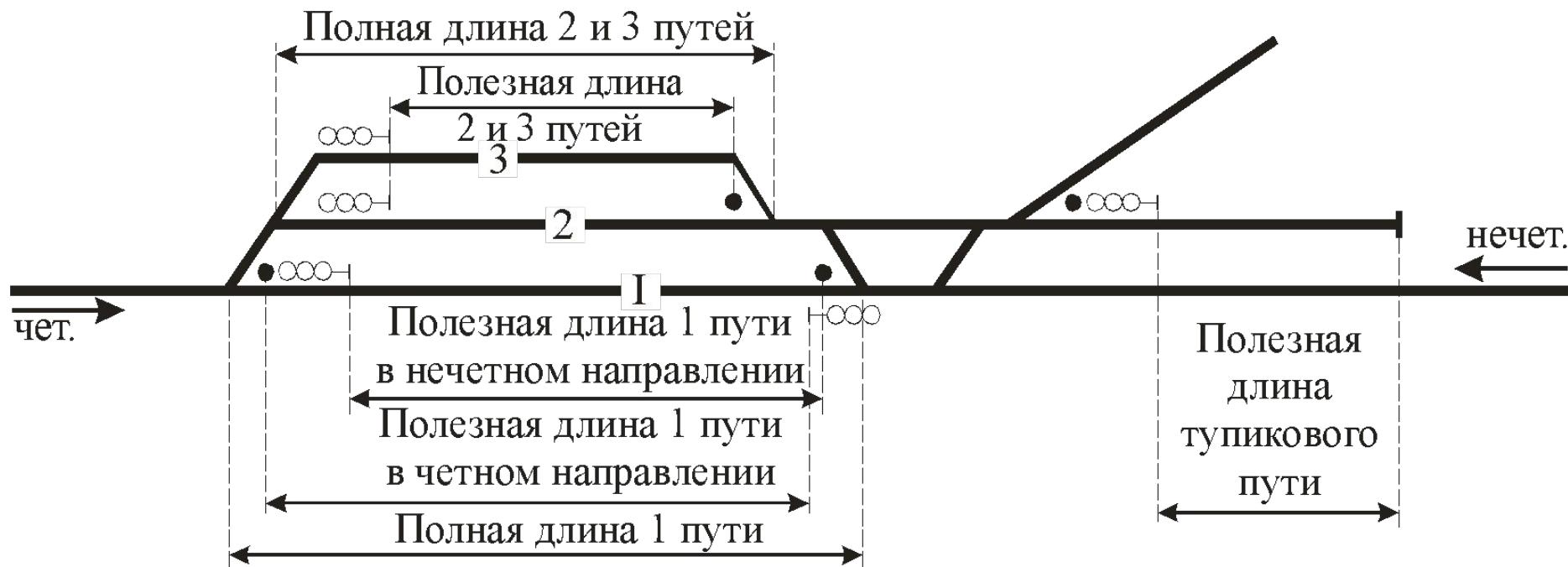
**Полная длина пути** – это расстояние между стыками рамных рельсов стрелочных переводов, ограничивающих этот путь. Для тупикового пути полная длина – это расстояние от стыка рамного рельса стрелочного перевода - до упора.
