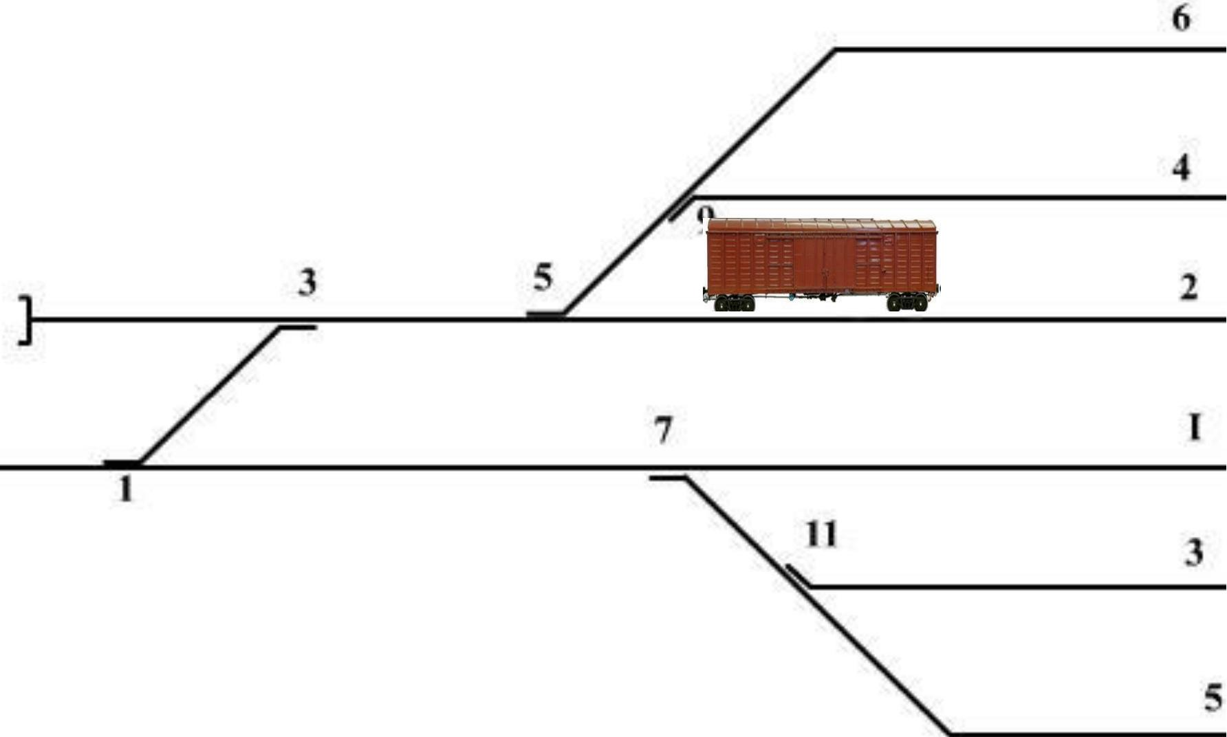
Предохранительный тупик - тупиковый железнодорожный путь, предназначенный для предупреждения выхода железнодорожного подвижного состава на маршруты следования поездов.
