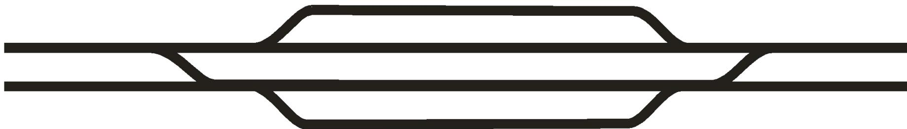
**Обгонный пункт** – раздельный пункт на двухпутных железнодорожных линиях, имеющий путевое развитие, допускающее обгон поездов и в необходимых случаях - перевод поезда с одного главного железнодорожного пути на другой.
