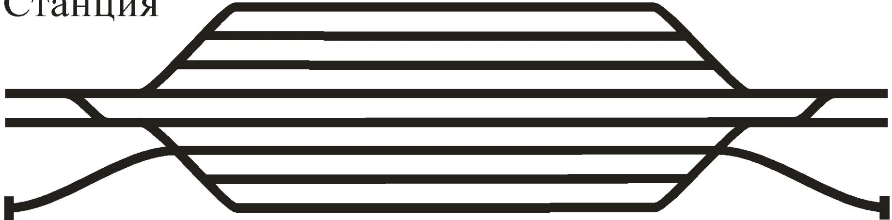
**Железнодорожная станция** - пункт, который разделяет железнодорожную линию на перегоны или блок-участки, обеспечивает функционирование инфраструктуры железнодорожного транспорта, имеет путевое развитие, позволяющее выполнять операции по приему, отправлению и обгону поездов, обслуживанию пассажиров и приему, выдаче, грузов, багажа, грузобагажа, а при развитых путевых устройствах - выполнять маневровые работы по расформированию и формированию поездов и технические операции с поездами.
