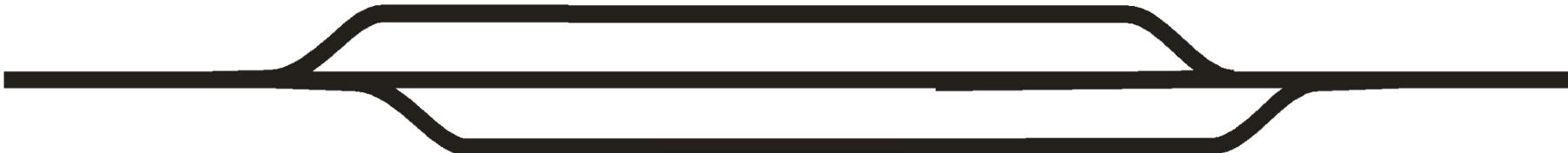
**Разъезд** – раздельный пункт на однопутных железнодорожных линиях, имеющий путевое развитие, предназначенное для скрещения и обгона поездов.
