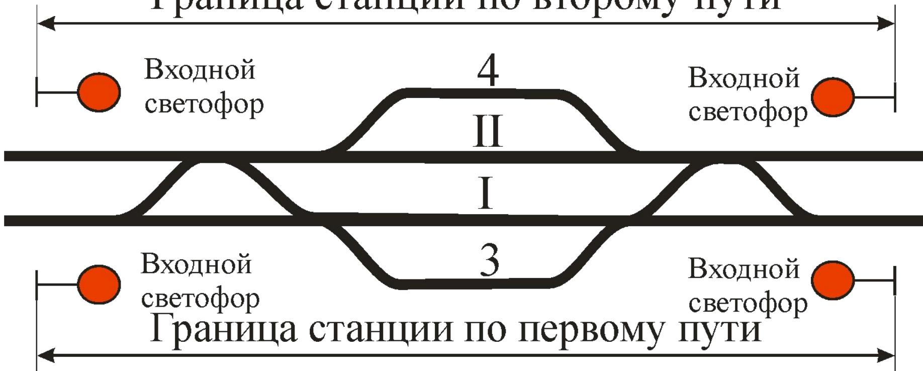
На двухпутных участках, оборудованных двухсторонней автоблокировкой, а также, где установлены входные светофоры для приема поездов по неправильному железнодорожному пути, границей железнодорожной станции по каждому в отдельности главному железнодорожному пути являются **входные светофоры**.
