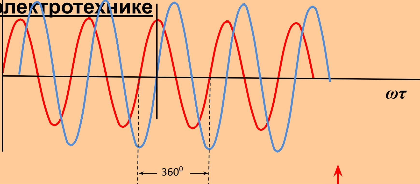
Символический вектор – графическое изображение синусоидального тока в виде прямой, поворачивающейся против часовой стрелки вокруг центра, закреплённого в начале прямой. При этом длина символического вектора равна амплитуде, его проекция на вертикальную ось – мгновенному значению, а частота оборота соответствует частоте переменного тока.
