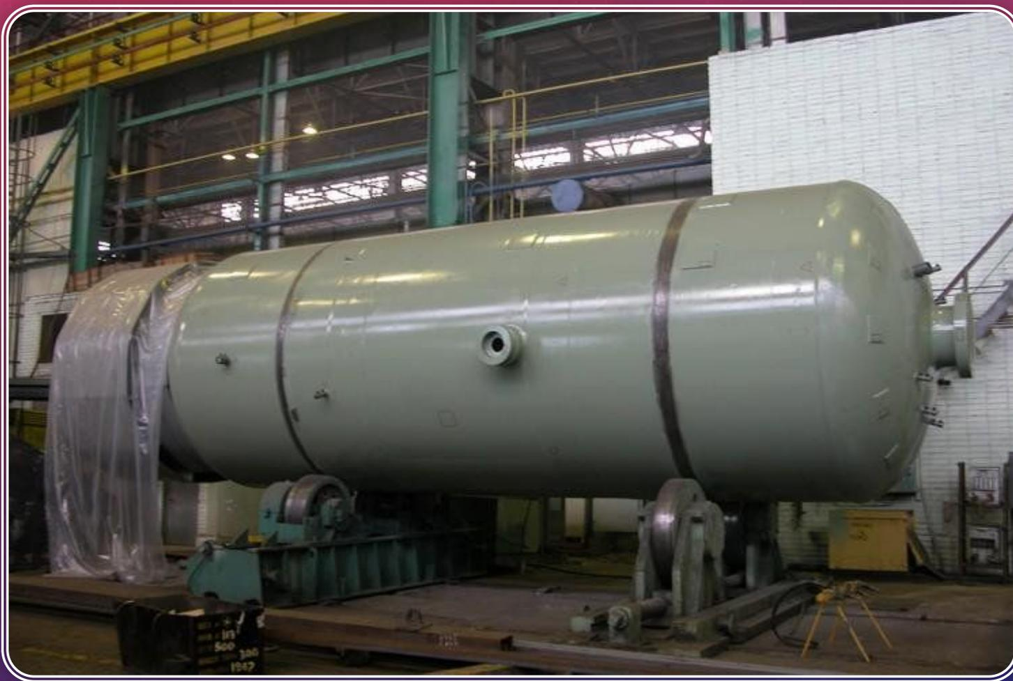
**Гидроемкости** - устройства, Предназначенные для содержания рабочей среды с целью использования Ее в процессе работы объемного гидропривода. К ним относятся гидробаки И гидроаккумуляторы. Гидробаки.
