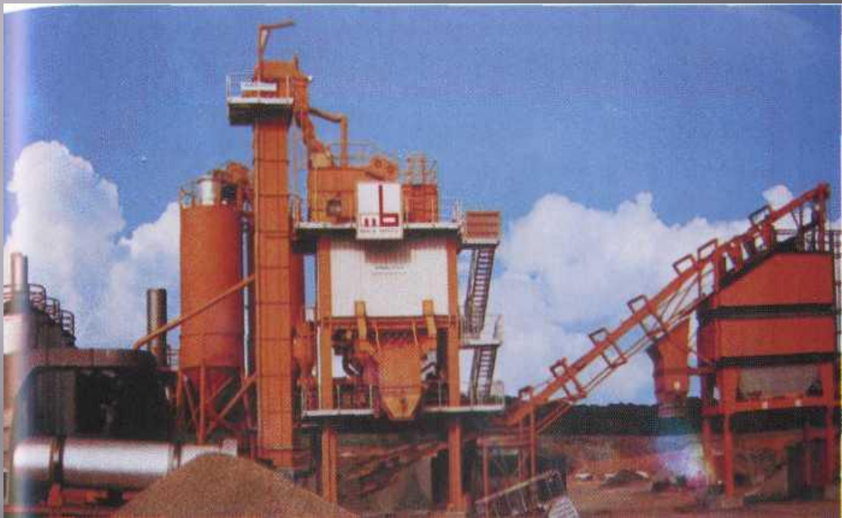
Асфальтосмесительная установка «CONCERT» фирмы «Benninghoven» (Германия)
