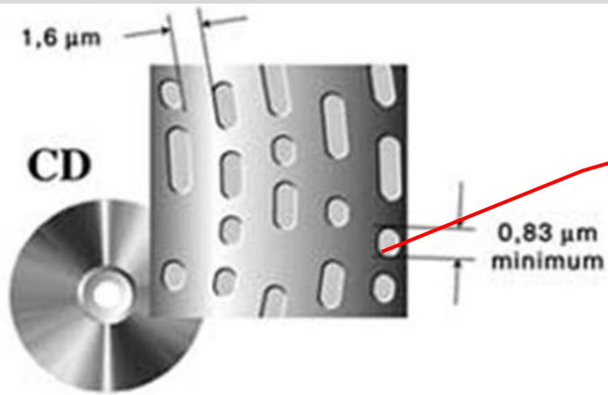
**CD-ROM под атомно-силовым микроскопом**
